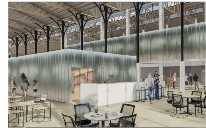
MÓDULO SOCIAL QUE ARTICULA ESPACIOS. CAJA REVESTIDA DE PROFILIT.
