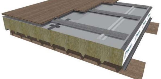
Esta solución se consigue mediante la instalación previa de perfiles metálicos. Estos anclajes se sueldan directamente a la superficie mediante termo fusión y permite colocar cualquier tipo de pavimento sea de madera natural o perfiles extruidos sintéticos imitación madera.
