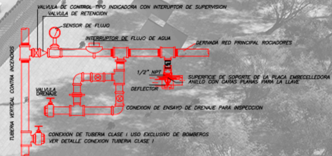
DISPOSICION ACEPTABLE DE LA TUBERIA DE SISTEMAS COMBINADOS DE ROCIADORES Y TOMAS DE MANGUERA NFPA 13 FIGURA A.7.10.1.3.1
