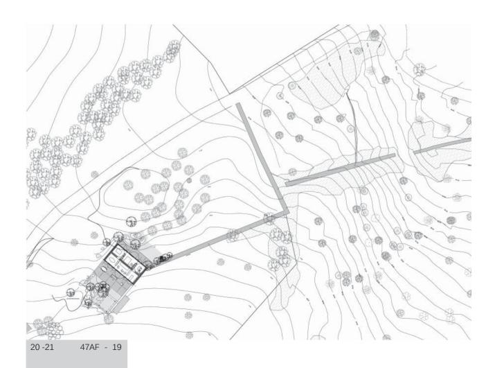
El proyecto consiste en la adaptación de la forma de uso tradicional de un refugio de pastores a la de vivienda mínima para uso esporádico. El planteamiento consiste en replicar simétricamente el volumen original para mantener las condiciones tipológicas y de funcionamiento técnico de una construcción aparentemente inocente que acumula decisiones inteligentes en cuanto a su orientación, ventilación, recogida de agua, etc.
