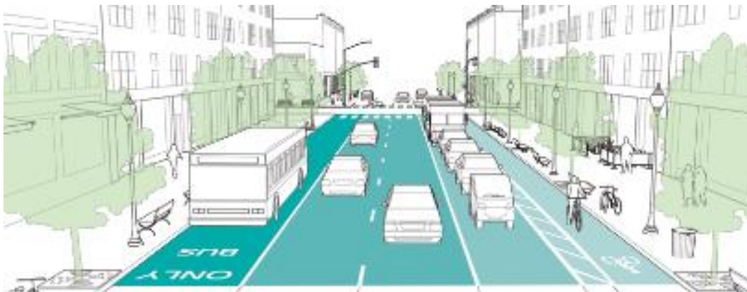
IMAGEN 113. ANCHOS DE CARRILES SEGÚN TIPO DE VÍA Fuente: NACTO, 2015
