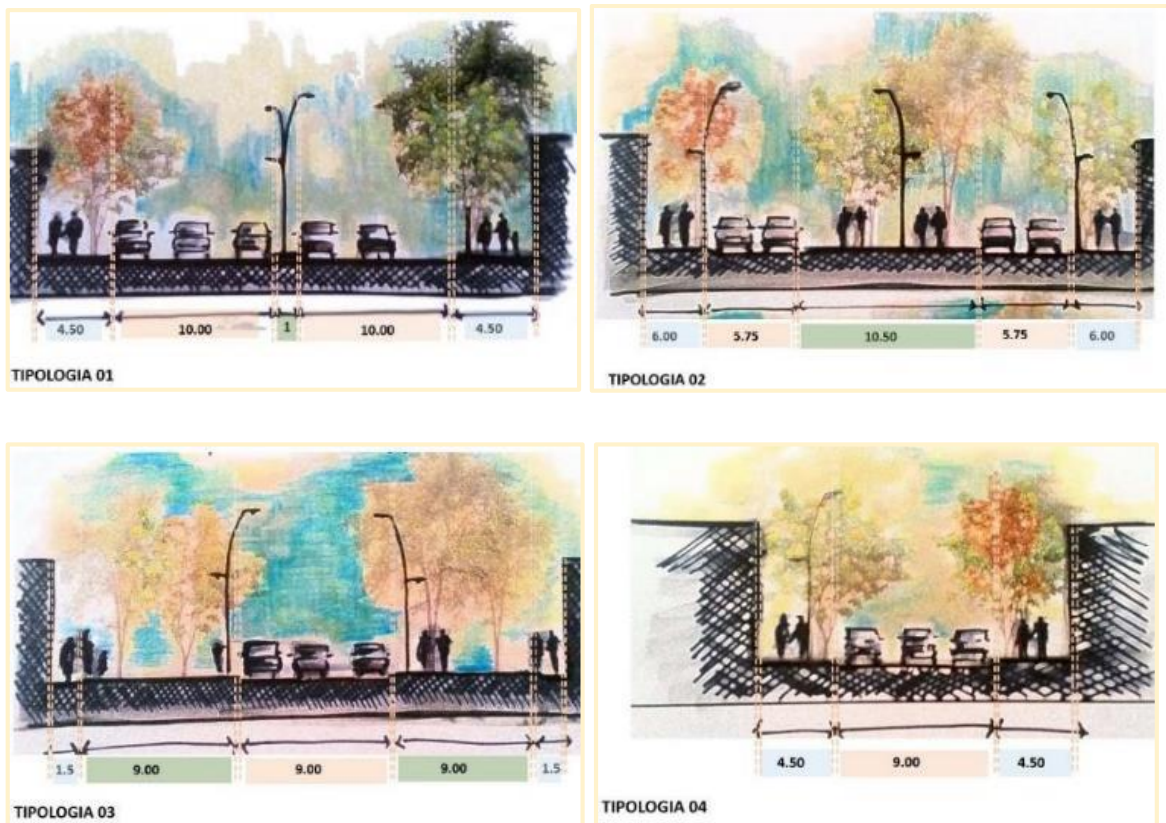
IMAGEN 95. SECCIONES TIPO VIAL PREDOMINANTES LA PLATA Fuente: Elaboración propia, en base a Morosi, 2015.
