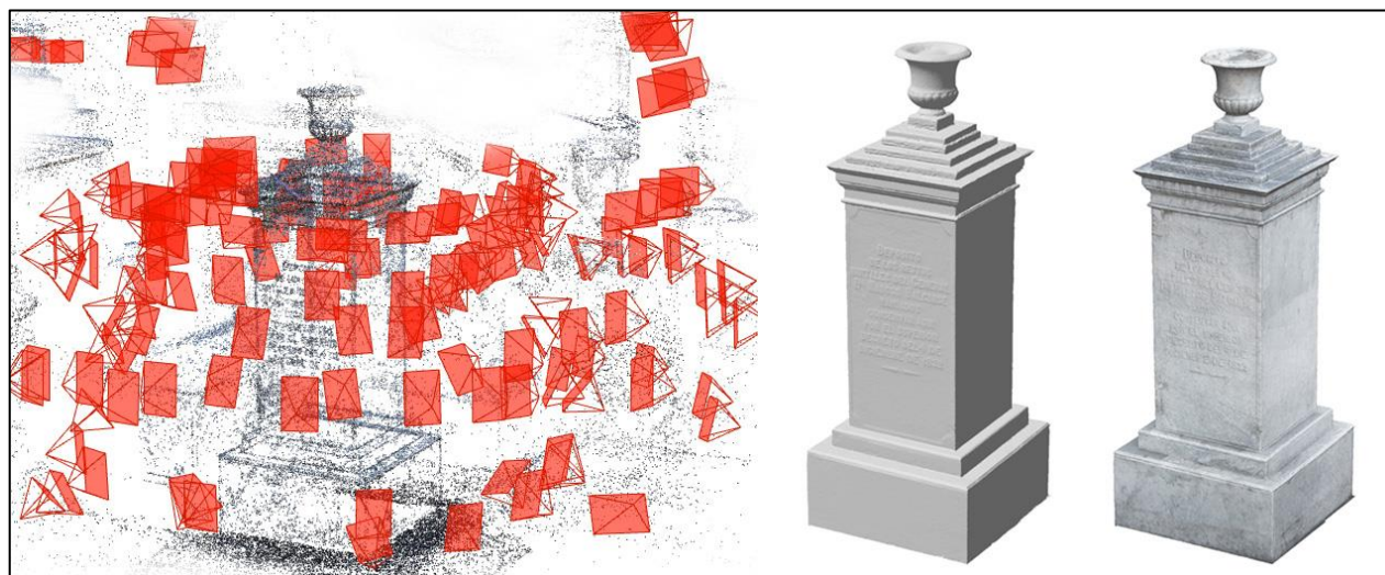
Figura 10. Representación del proceso completo de digitalización 3D con fotogrametría de SFM. Izquierda: nube de puntos dispersa del monumento al General Marcos Balcarse con la representación de la ubicación y orientación de las tomas fotográficas. Centro:
