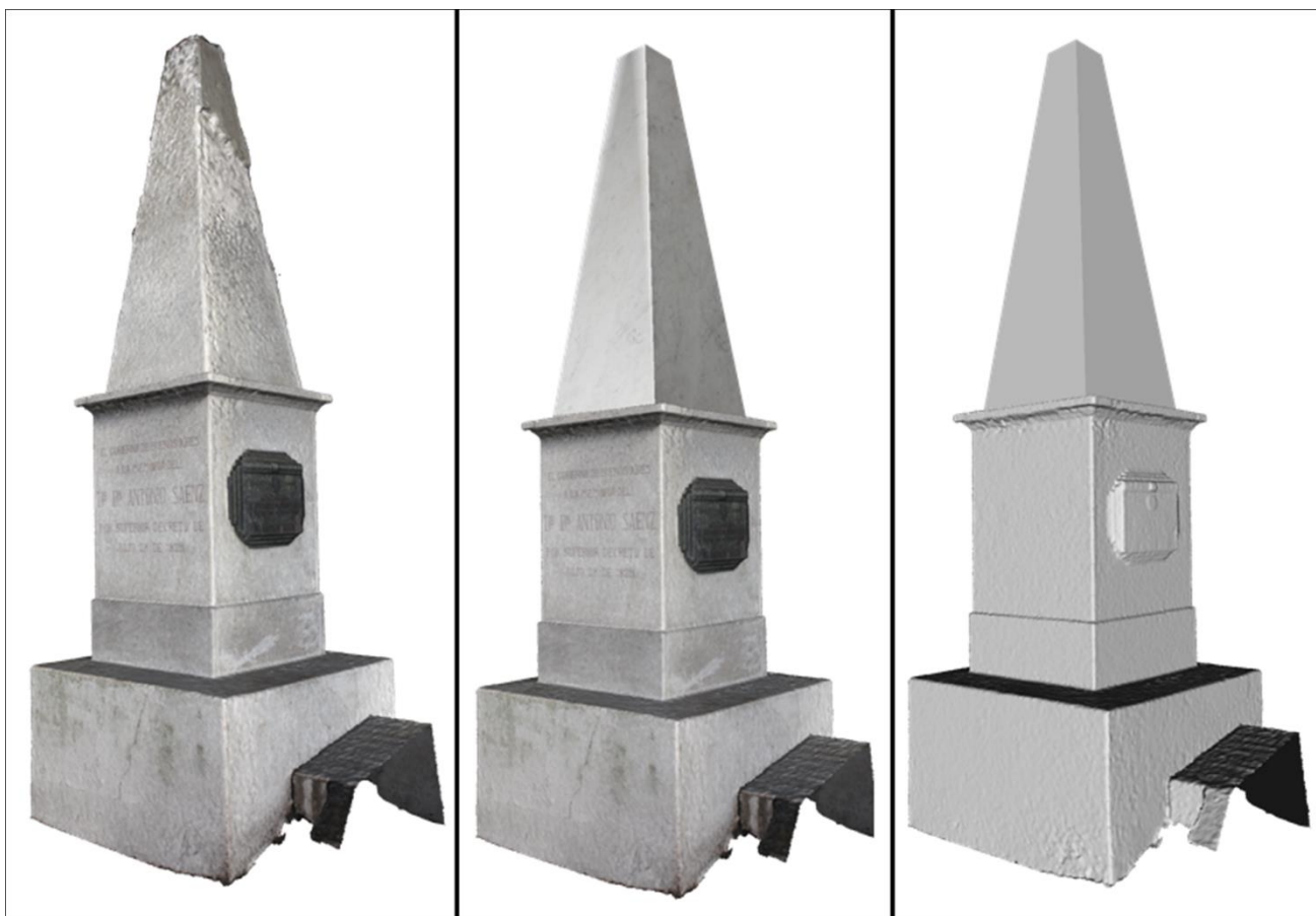
Figura 12. Izquierda: Malla 3D texturizada obtenida. Centro: Malla 3D corregida con técnicas de modelado y vuelta a texturizar. Derecha: Malla 3D final sin textura.
