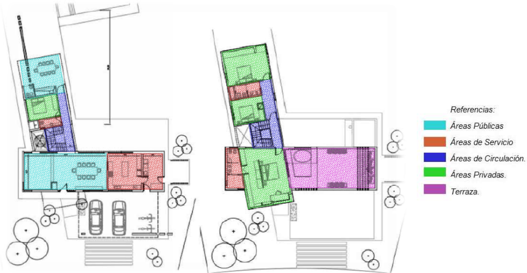
Imagen 7: Planta baja y alta en donde se identifican las diferentes áreas de la vivienda según programa.
