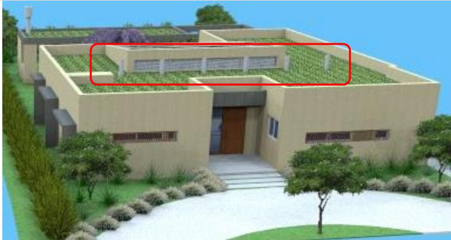
Figura 86: Ubicación de lumiductos en modelo 3d.
