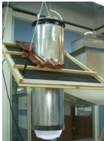
Figura 83 : Prototipo de lumiducto, diseñado por Juan Ignacio Carricaberry en sus estudios de grado.
