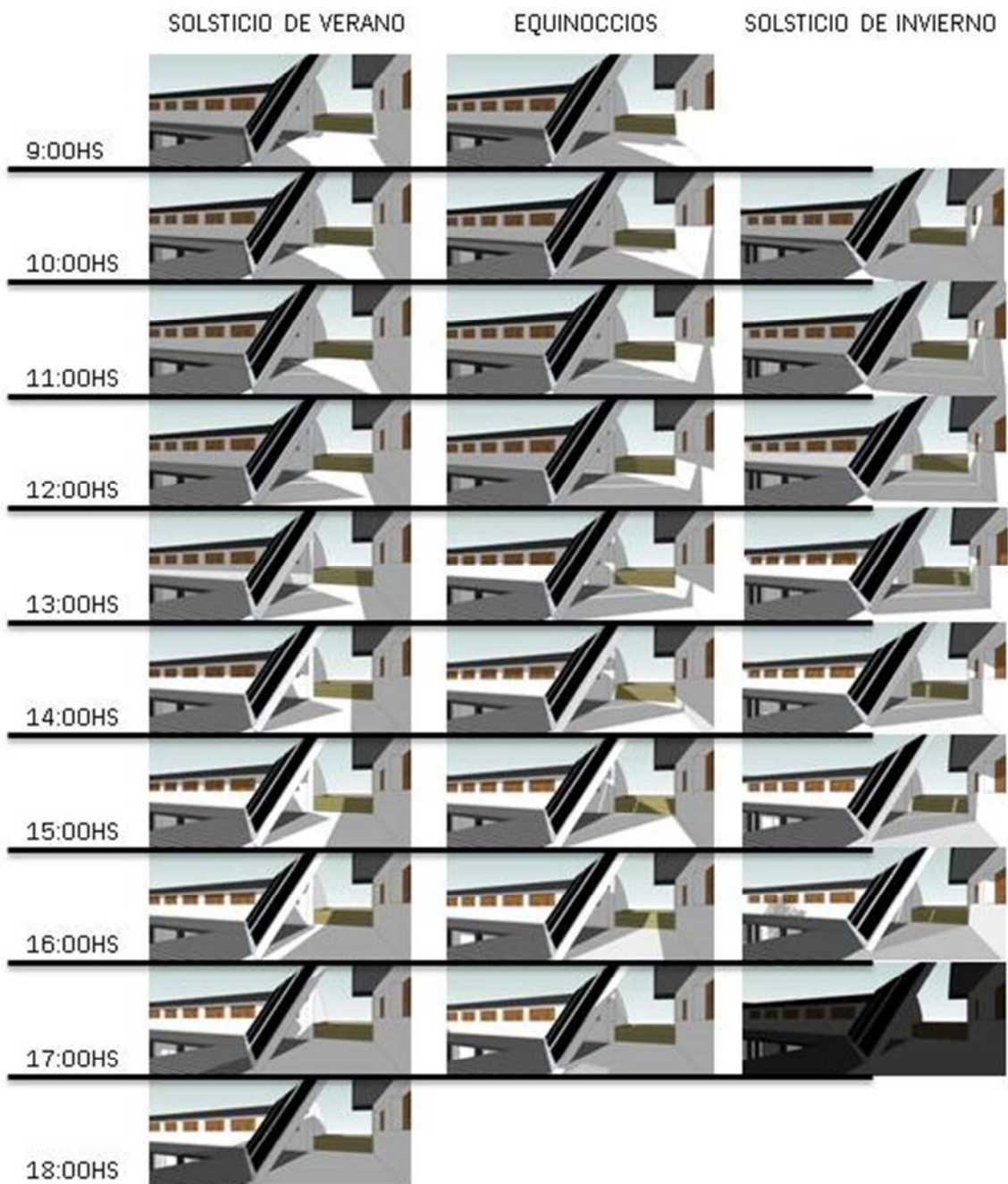
Figura 15: Incidencia solar en colectores de agua caliente sanitaria en solsticios y equinoccios.
