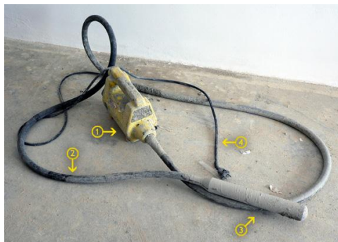
Imagen 25: Vibrador de agujas. Fuente: Fotografía de obra de Mar del Plata
