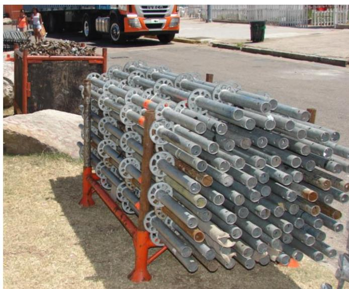
Imagen N° 54: Acopio de caños de estructura tubular y nudo.
