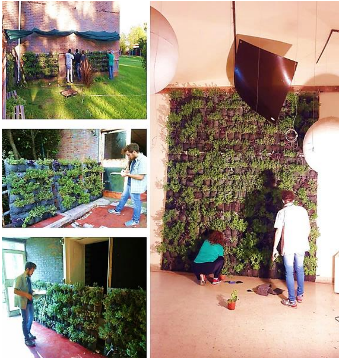
Figura 102 Traslado de la muestra en “condición ii” para su evaluación en cámara reverberante
