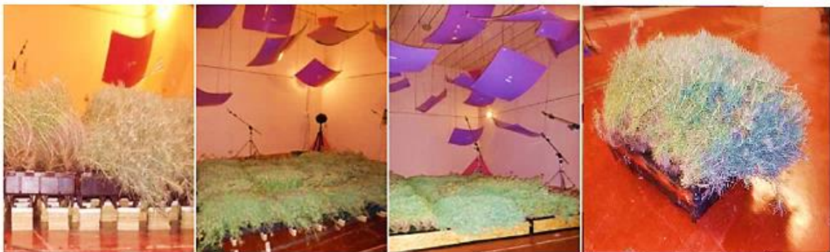
Figura 82 Ensayos de absorción acústica de módulos pre cultivados en laboratorio
