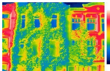
Fotografía infrarroja de una fachada cubierta por vegetación
