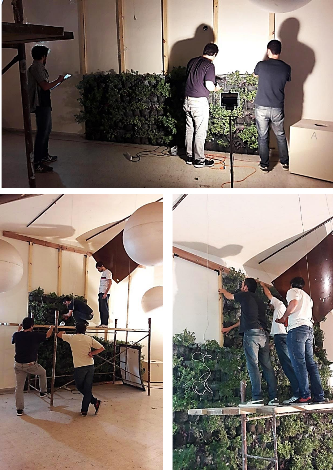
Figura 99 Disposición de la muestra del SJV en una de las paredes de la cámara reverberante Fuente: relevamiento propio
