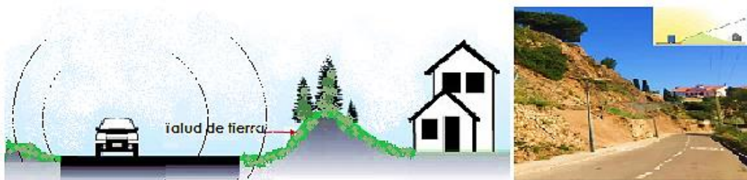
Figura 70 Barreras vegetales en forma de taludes
