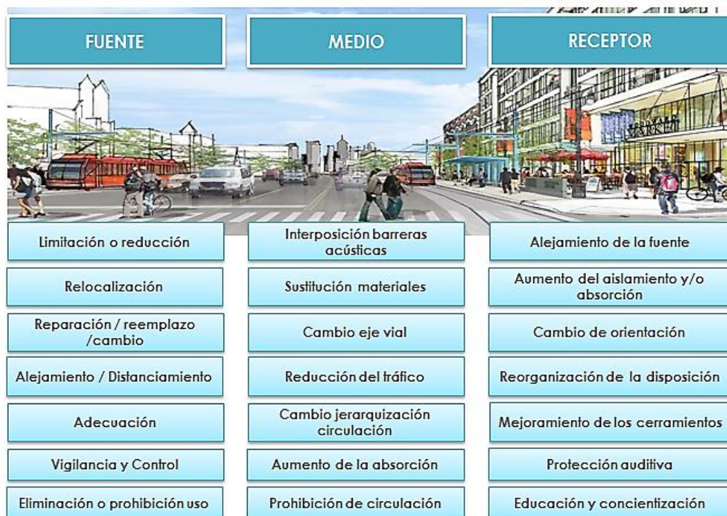
Figura 57 Posibles acciones para controlar la contaminación acústica
