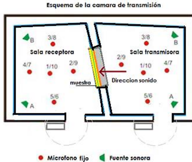
Figura 112 Posiciones de micrófonos y fuentes en relación a la muestra durante la medición de aislamiento acústico.
