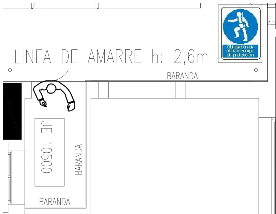
Figura 14. Instalación unidad exterior AA.
