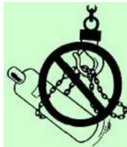
Figura 7. Prohibición de usar ganchos o cables para elevación de tubos con gases. Fuente: NTP nº495 del Instituto Nacional de Seguridad y Salud en el Trabajo de España
