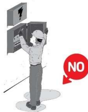
Gráfico N° II.39: Manipulación inadecuada de tableros eléctricos.
