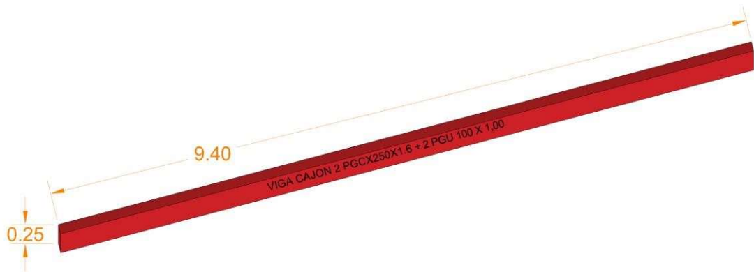
Gráfico N° II.16: Imagen de viga cajón
