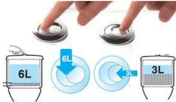
Ilustración 18 Doble pulsador en mecanismo de doble descarga
