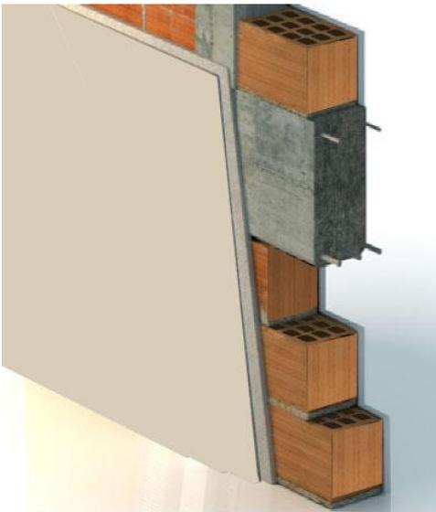
Ilustración 2 Corte perspectivado del sistema de muro utilizado
