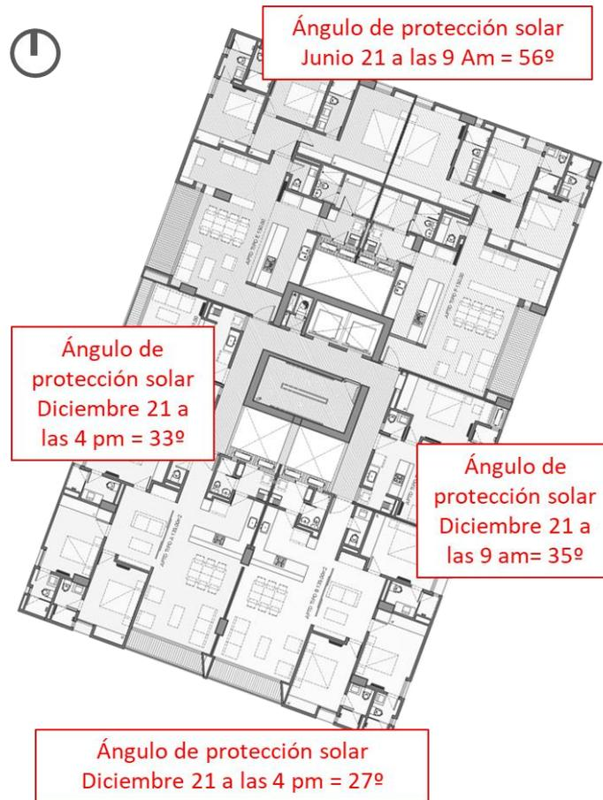
Figura 39. Ángulos de protección solar propuestos para cada fachada
