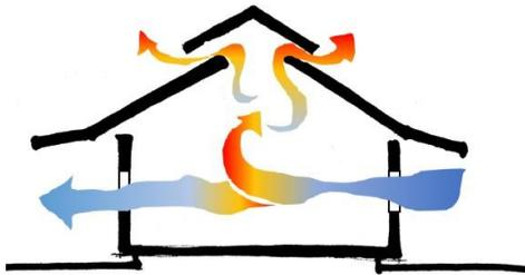
Figura 8-52: Ventilación por desplazamiento convectivo
