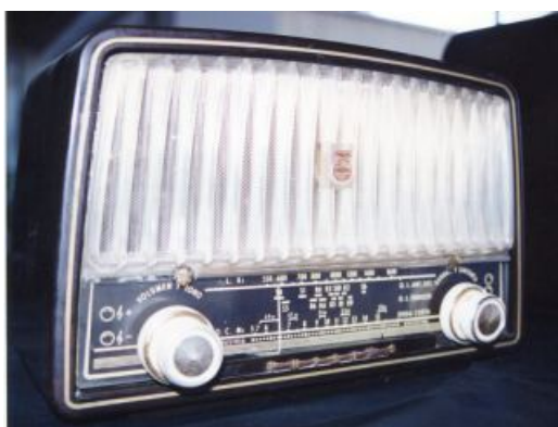
Los plásticos fueron incorporándose progresivamente a los gabinetes de los receptores, pero no remplazarían a la baquelita hasta que los transistores no sustituyeran a las válvulas electrónicas.
