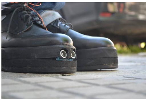
Figura N 3. Calzado háptico con navegabilidad asistida. Fuente Universidad Nacional de La Plata
