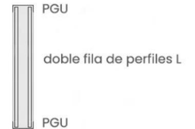
**Vigas revestidas de paneles de aluminio compuestos:** panel compuesto por dos láminas de aluminio y un núcleo mineral. Ventajas: estabilidad térmica, bajo peso, rápida instalación, no requiere mantenimiento
