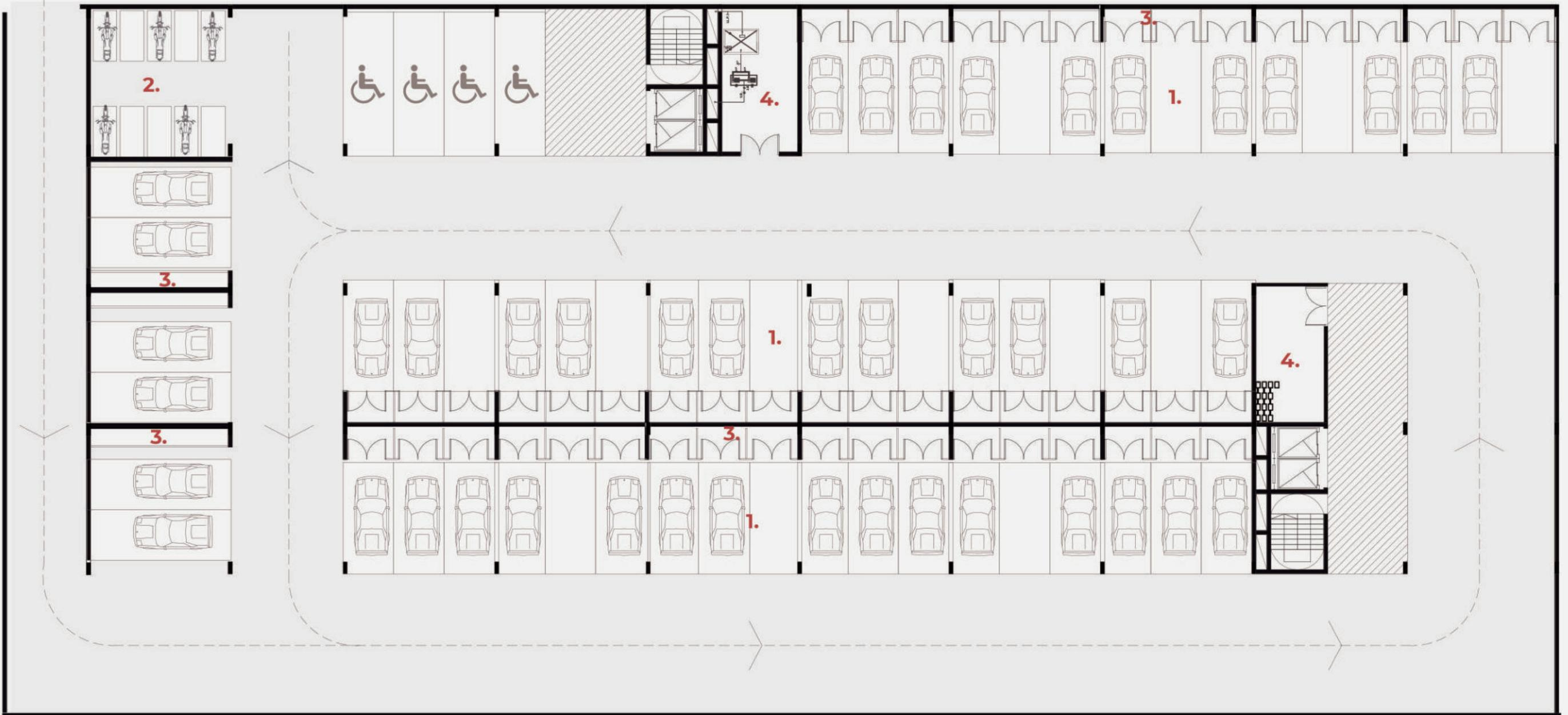
1. ESTACIONAMIENTO AUTOS / 2. ESTACIONAMIENTO MOTOS / 3. BAULERA / 4. SALA DE MAQUINAS
