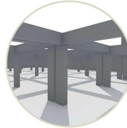
El **subsistema de sostén vertical** está constituido por un subsistema de columnas de hormigón armado, siendo dobles donde se necesiten juntas de dilatación, junto a un subsistema de tabiques perimetrales de submuración. A demás, de dos núcleos verticales de hormigón armado.
