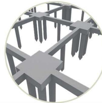
El **subsistema de fundación** se realizara mediante un cabezal de hormigón armado in situ con cuatro, o seis, pilotines unidos por vigas de arriostamiento que permiten el trabajo en conjunto. Se fundara en dos profundidades diferentes dependiendo el sector.
