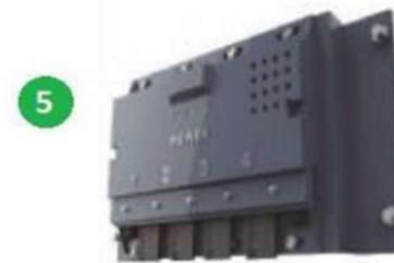
5 Dispositivo de inspección, basado en la resistencia que controla el estado de la cinta de acero recubierta
