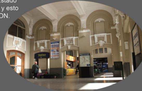
Hall de Entrada: la estructura de muros portantes que conforma el edificio, se encuentra en buen estado. Ha tenido trabajos de mantenimiento en los últimos años. Revoques y pintura en buen estado.
