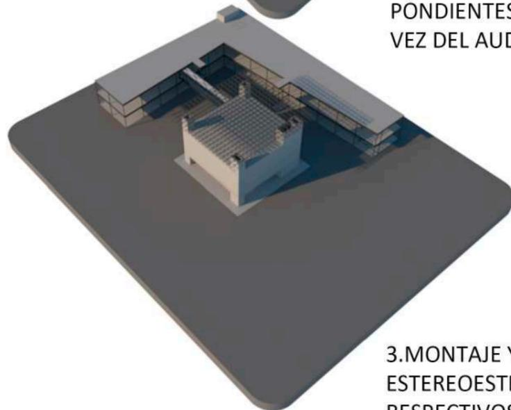
3. MONTAJE Y COLOCACIÓN DE LA ESTEREOESTRUCTURA CON SUS RESPECTIVOS ANCLAJES A LAS COLUMNAS DE HªAª.
