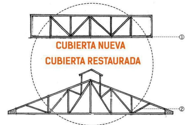
1. Viga reticulada plana de 1,00 m de alto, realizada con perfiles C. | 2. Viga reticulada triangular, realizada con perfiles L.
