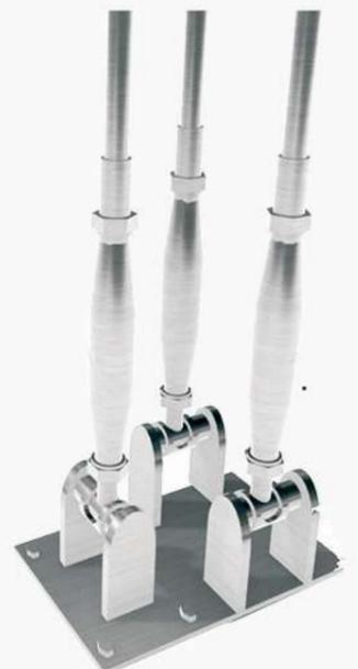
Detalle tensor en viga
