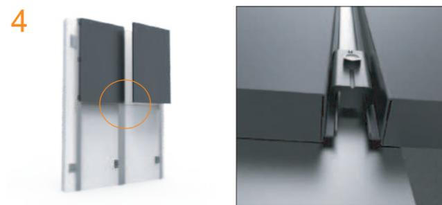
4. Una vez nivelados los paneles se fijan mediante los clips de fijación en el sentido longitudinal del panel, ubicar 3 clips de forma simétrica a lo largo de cada panel con un distanciamiento de los bordes de 1.25" (35mm). Los clips se fijan a los perfiles de soporte utilizando tornillos autoperforantes 8x3/4" HWH.
