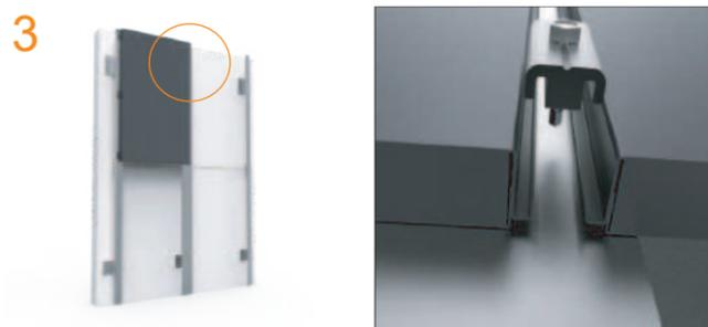
3. Posicionar los paneles siguiendo el trazado definido ahora por la subestructura. El sistema QC100 en orientación horizontal debe instalarse de arriba hacia abajo. Nivelar los paneles en ambos sentidos para obtener canterías uniformes.
