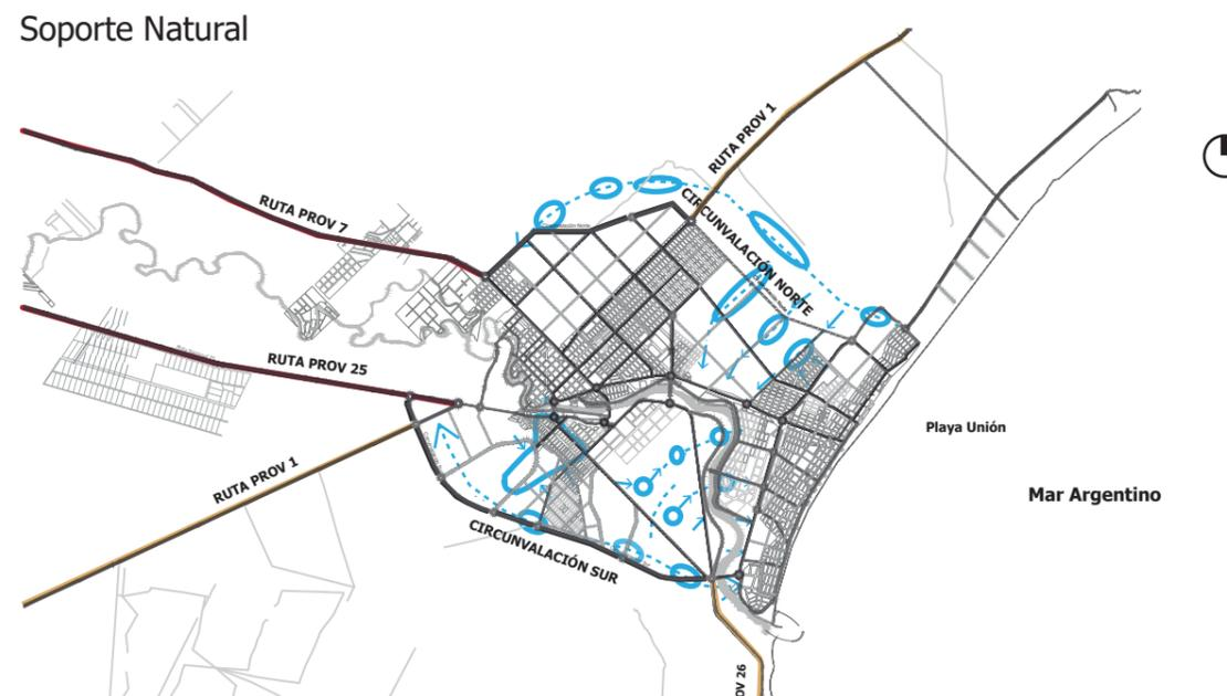
El uso de zonas de acumulación de aguas de lluvia como elemento complementario del sistema integral de gestión del drenaje pluvial. La principal característica de estas zonas debe ser que permitan alojar un volumen suficiente de agua como para atenuar los caudales picos generados en el momento de mayor intensidad o bien para recibir el volumen de agua precipitada en aquellos casos donde la descarga no pueda ser libre o a gravedad.
