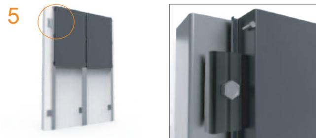
5. Fijar autoperforantes en las aletas de cada panel, cerca de las esquinas, para impedir el deslizamiento de los paneles. En caso de expansión térmica, todos los paneles se mueven en la misma dirección.
