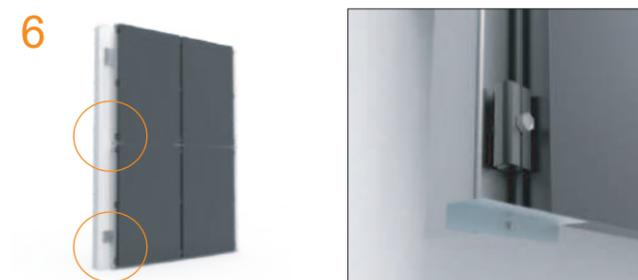
6. En el borde inferior de cada panel fijar ángulo 25x12x1.3mm a los perfiles de soporte L y T. Nota: El ángulo se entrega en longitudes de 6000mm para ser cortado en obra en tramos de 100mm aprox.
