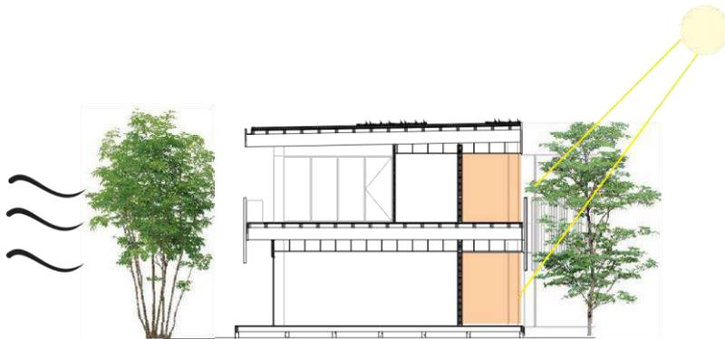
Lado sureste con barrera de árboles para control del viento, y galerías del lado noroeste para proteger de las temperaturas extremas.
