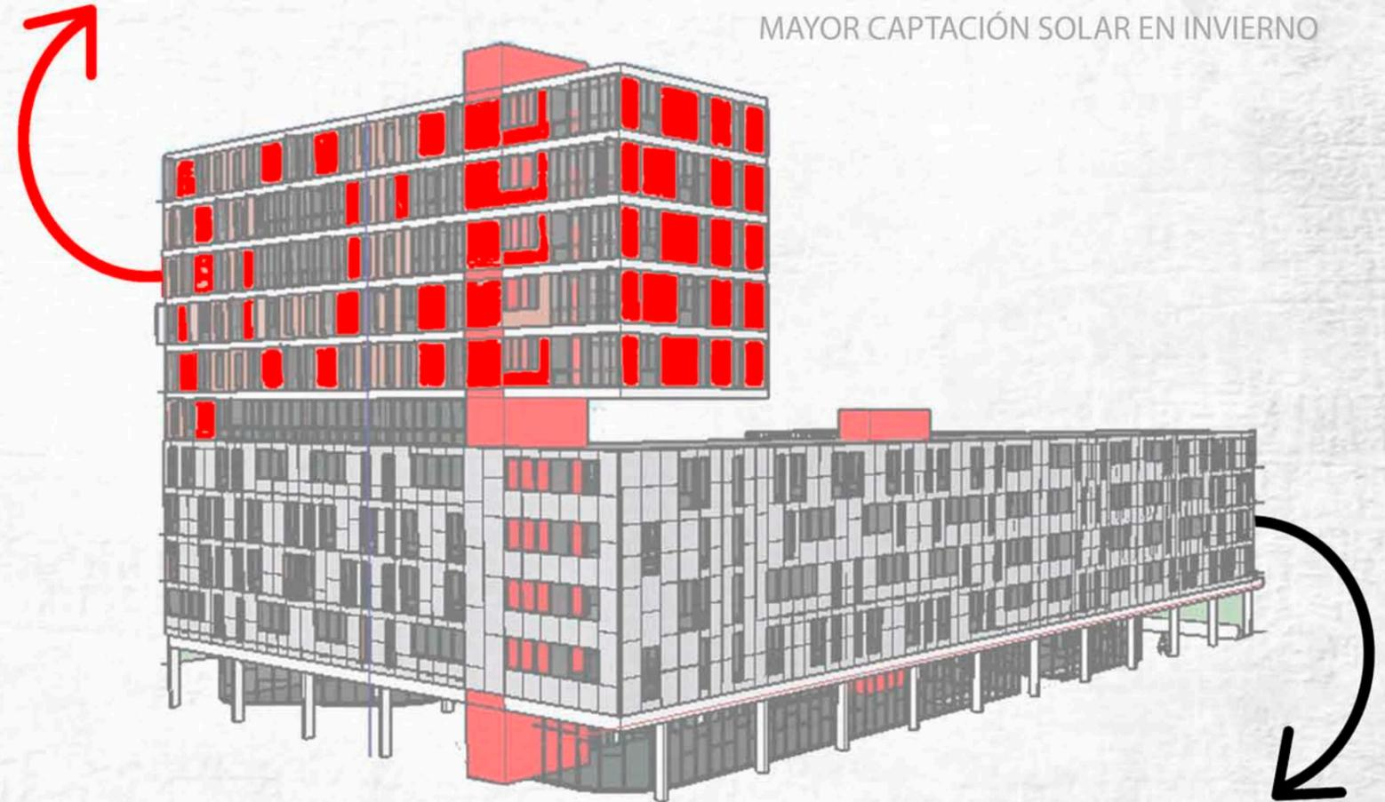
Mientras en los niveles inferiores, se optó por cubrir las superficie opaca de las tipologías mediante PLACAS CEMENTICIAS, para darle un aspecto mas pesado al basamento.
