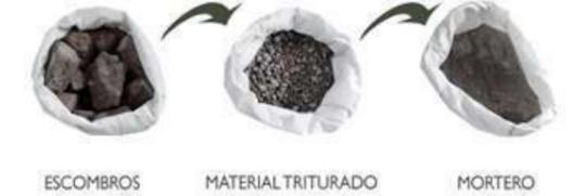
Ya que la obra contiene una etapa de demolición importante, se propone reutilizar los escombros y con ellos poder realizar los nuevos pavimentos ahorrando en el costo de materiales y el transporte del residuo.
