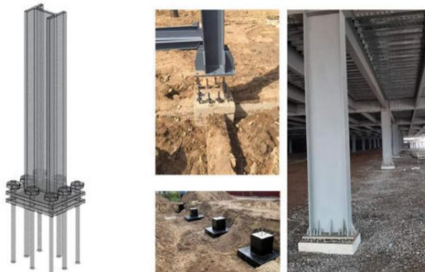
Anclaje columna - viga
