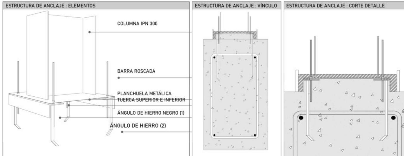
La estructura principal del galpón se conforma a partir de un sistema metálico formado por columnas y vigas IPN 300 soldadas entre si, con sus respectivos refuerzos en los nudos para mayor rigidez.
