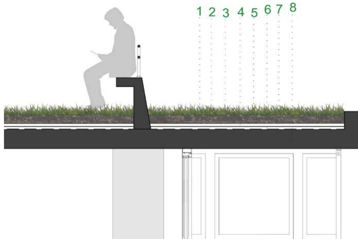
01. Vegetación 02. Sustrato 03. Geotextil 04. Drenaje 05. Membrana impermeabilizante anti-raíz 06. EPS 3CM 07. Pintura asfáltica 08. Losa de hormigón de 22cm (entrepiso sin viga) 09. Banco premoldeado de H°A° con baranda tubular de hierro.
