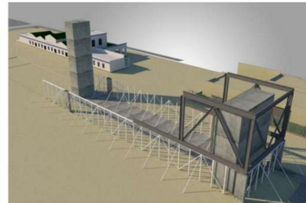
3. Se completa un nudo de la estructura principal. Al completarse la escuadra, la estructura estará estable para poder continuar con la colocación de los tramos siguientes.
