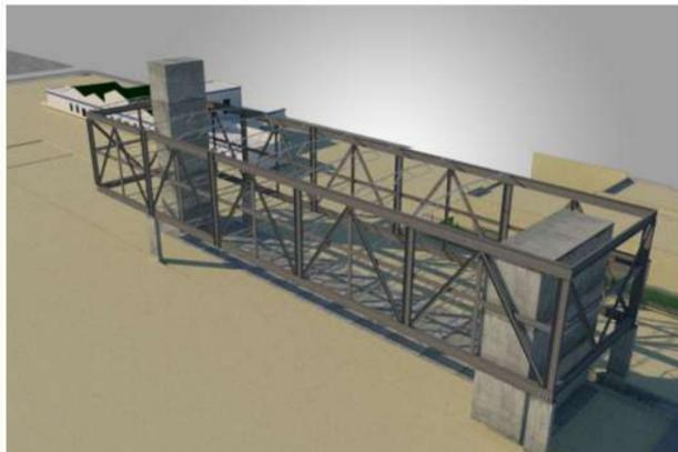
5. Montado de estructura secundaria (Vigas reticuladas prefabricadas de techo y entrepiso). Se colocan los tensores en cruz donde corresponda. En este punto la estructura se encuentra rígida y se quitan los puntales.
