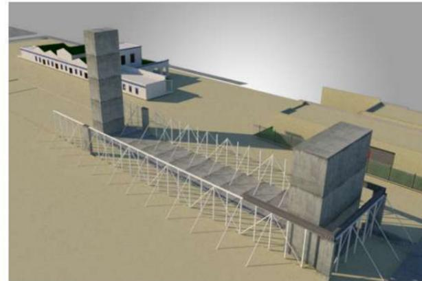
2. Apuntalado y montado del primer cordón de la estructura principal que será la que mantendrá la continuidad durante toda la estructura.
