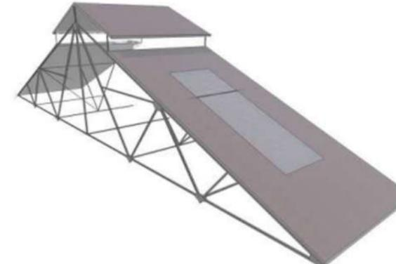
**CUBIERTA DE CHAPA A DOS AGUAS CON ESTRUCTURA CABIADA METÁLICA**
