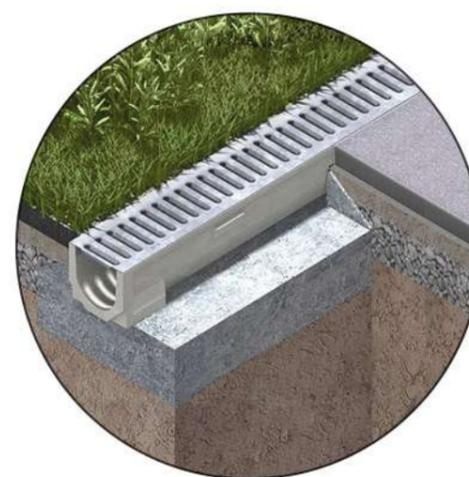
Canal de drenaje prefabricado recolector de agua de pisos, con caño aislado conductor de agua de lluvia de canaletas a cisterna de almacenamiento
