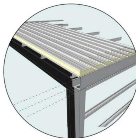
Estructura, cubierta de panel sandwich, canaleta y caño de bajada de chapa galvanizada
