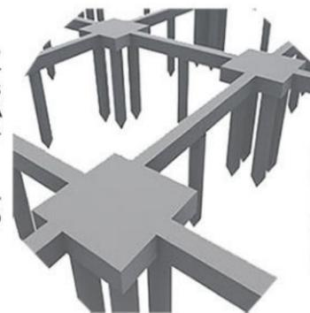
El subsistema de fundación se realizara mediante un cabezal de hormigón armado in situ con cuatro, o seis, pilotines unidos por vigas de arriostramiento que permiten el trabajo en conjunto. Se fundara en dos profundidades diferentes dependiendo el sector.
