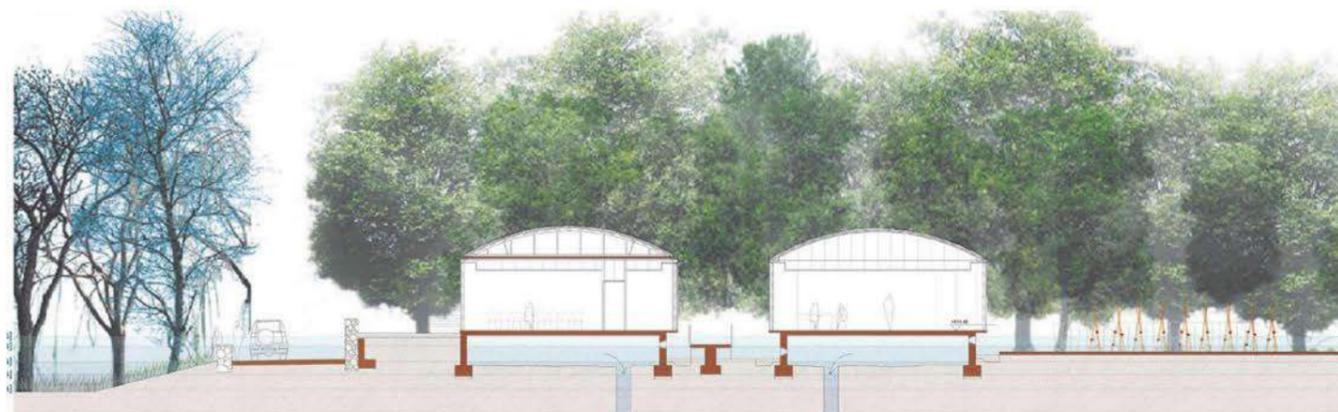
El edificio se plantea en una sola planta. Tres naves largas separadas entre sí y articuladas a través de un vestíbulo conforman un edificio que se eleva un metro sobre el terreno para protegerse de las inundaciones
