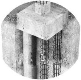
Para las fundaciones de la estructura puntual se utilizaron cabezal de pilotines según cálculo
