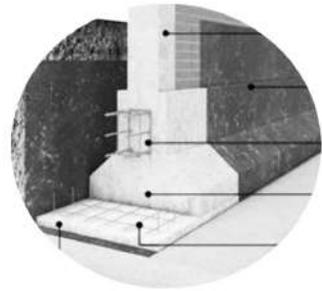
Para las fundaciones de los tabiques de hormigón armado se utilizaron zapatas corridas
