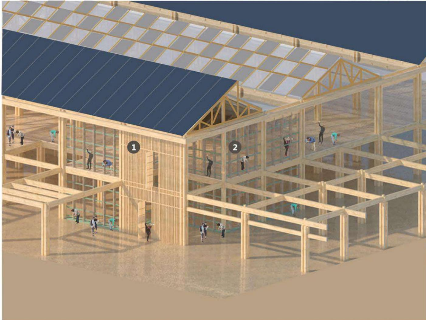
1 Montaje de terminación de paneles Plataform frame + 2 Montaje de parasoles -en sector donde la terminación del envoltente ya esta terminada-
