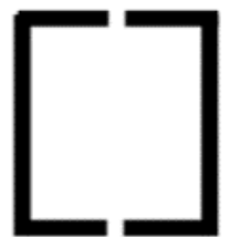
2 PERFILES PNU 180, PARA CONFORMACION DE COLUMNAS.
