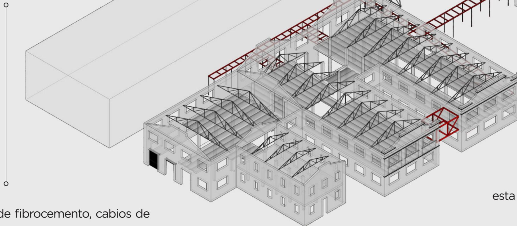
de fibrocemento, cabios de madera y cabreadas metálicas. Las canaletas de desagüe pluvial se encuentran ubicadas en el lado interno del muro.
