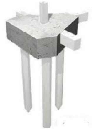
Se utilizan distintas cantidades de pilotes en los cabezales según la exigencia de cada línea de columna.
