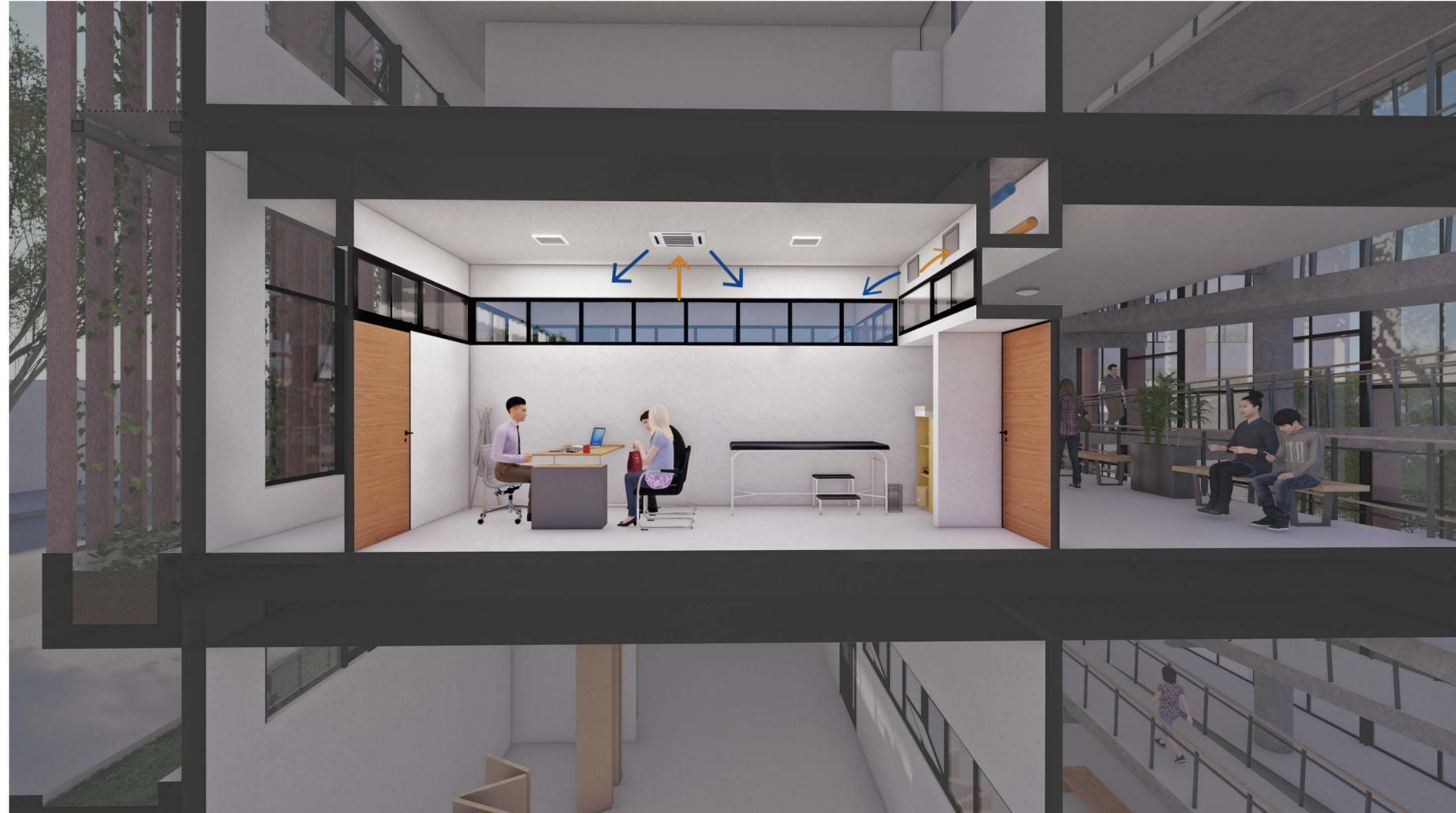
El sistema pasivo de acondicionamiento térmico del edificio se lo complementa con sistemas activos. Se va a usar un sistema zonal, para el auditorio, y sistemas centrales para el resto.
