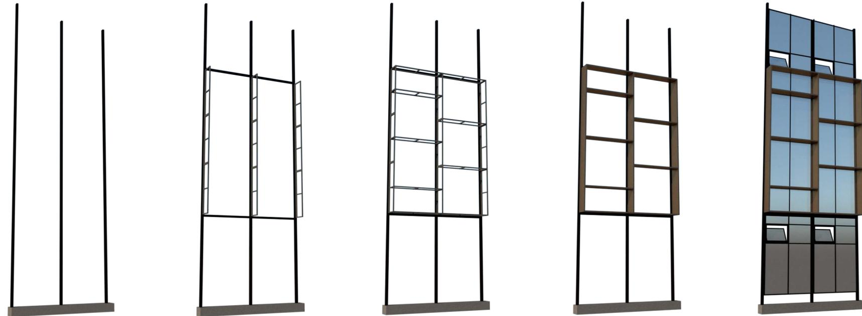
Para la construcción de la fachada noreste, que da al interior del patio, las piezas soldadas se van a mandar a realizar en taller para luego ser trasladadas al sitio y luego montar todo en obra.
