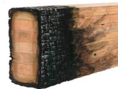
Muestra de viga expuesta al fuego y su resistencia ignífuga
