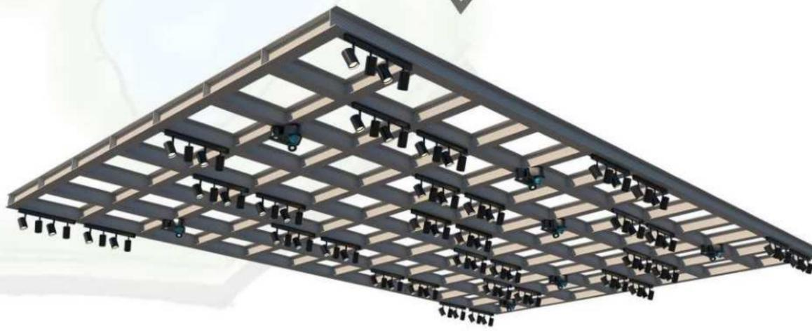
BANDEJA CON ILUMINACION LED EN LA CUBIERTA LAMPARA CON CABEZALES MOVILES QUE VAN ANCLADOS A LA GRAN BANDEJA
