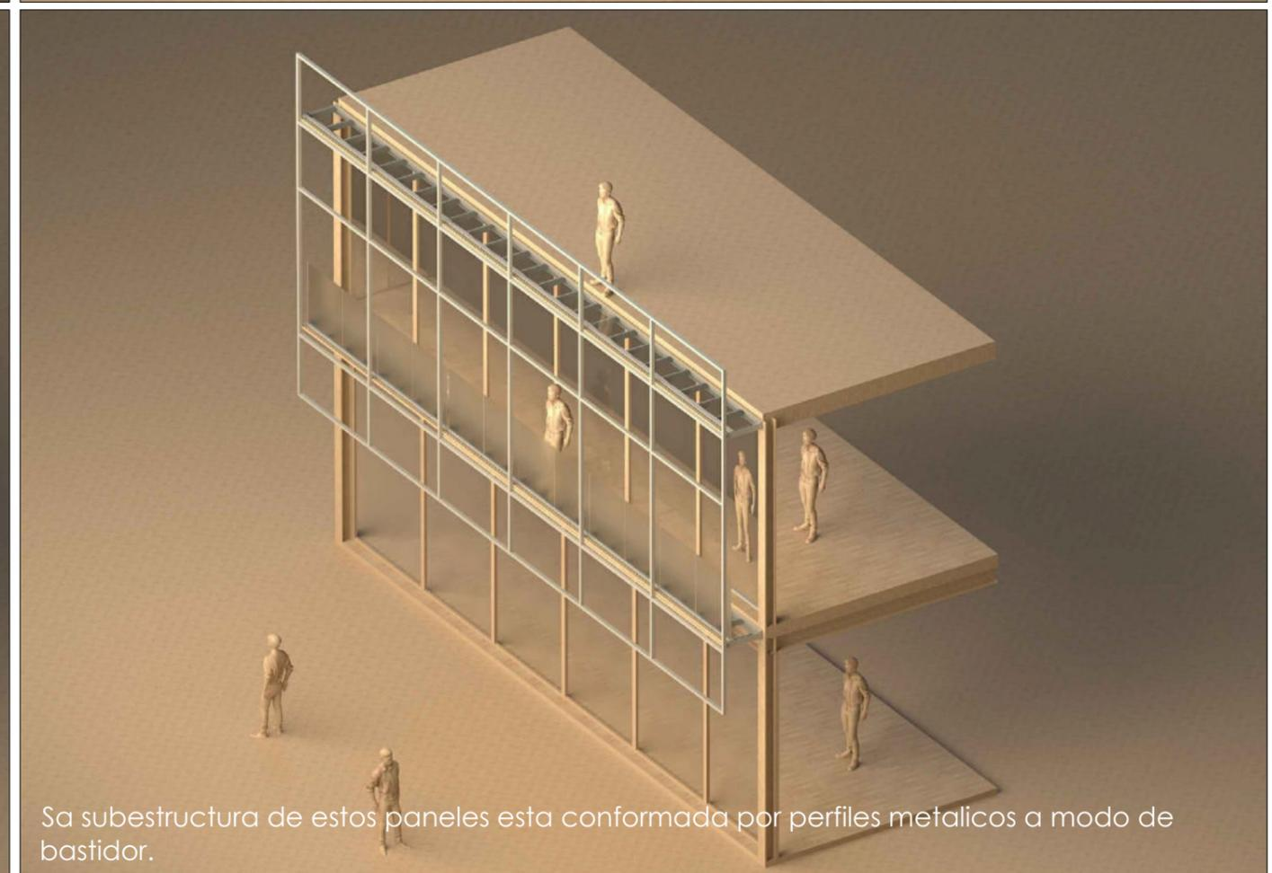
Sa subestructura de estos paneles esta conformada por perfiles metalicos a modo de bastidor.
