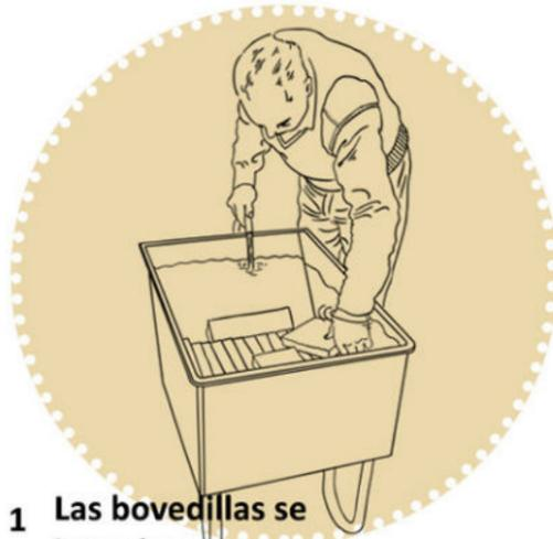
1 Las bovedillas se introducen en agua
