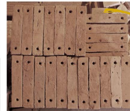
Perforaciones: Se ligan con varillas metálicas y unen dentro de un bastidor metálico.
