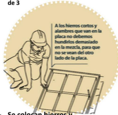
A los hierros cortos y alambres que van en la placa no debemos humedificarlos demasiado en la mezcla, para que no se vean del otro lado de la placa.
