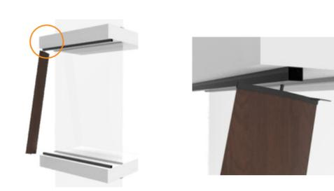
Acoplar el buje de PVC en las perforaciones (en el perfil soportante superior). Encajar el eje largo del panel en el buje de PVC y moverlo hacia arriba para encajar el eje corto en el perfil inferior.
