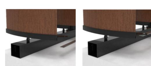
Una vez instalados todos los paneles en los perfiles tubulares se procede a instalar la barra de accionamiento para permitir un movimiento unificado de los paneles. Esta barra se fija a las orejas de las tapas del panel Termobrise mediante un perno maquina de 1/4" x 3/4" con tuerca de seguridad 1/4" y golilla 1/4"
