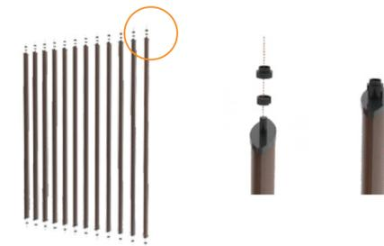
Se arman los soportes de las paletas, esto se consigue uniendo las tapas de eje largo sin oreja con un buje y un anillo de pvc. Listas para instalarse en los perfiles tubulares de soporte.
